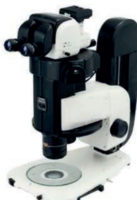
SMZ25 с моторизованной эпифлуоресцентной насадкой и диаскопическим LED-штативом
