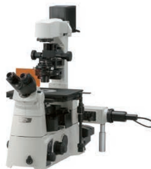
Ti-U в комплекте с эпифлуоресцентным освещением
