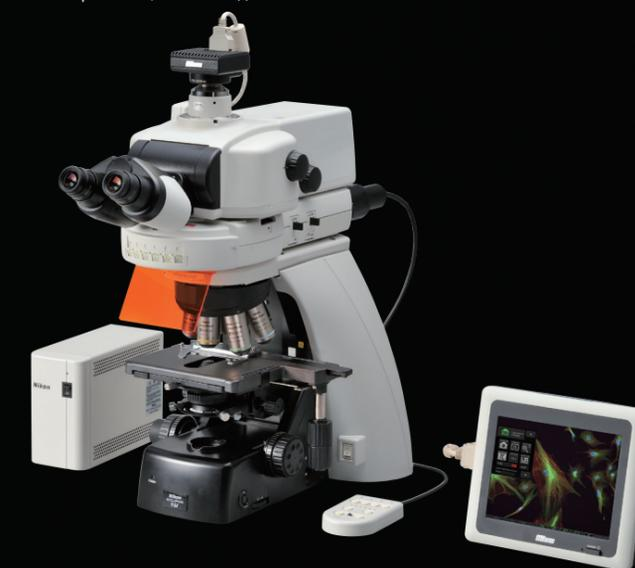
Конфигурация микроскопа серии Ni-U с ручным управлением, с моторизованной эпифлуоресцентной турелью, эпифлуоресцентной насадкой, моторизованным револьвером на 6 объективов, цифровой камерой DS-Qi1 и DS-Fi2, блоком управления DS-L3, простым пультом дистанционного управления, блоком управления B
