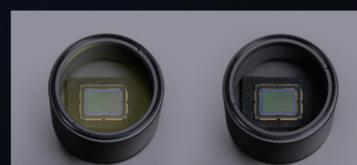
Без нанокристаллического покрытия      С нанокристаллическим покрытием
