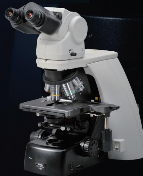
Микроскоп серии Ni-U в конфигурации с бинокулярным тубусом.
